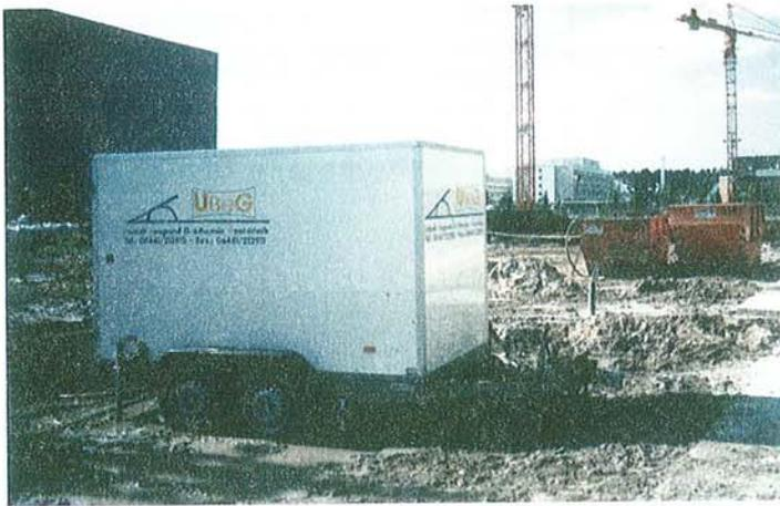
Abb. 2: Anhänger mit Gerät für Thermal Response Test im Einsatz
